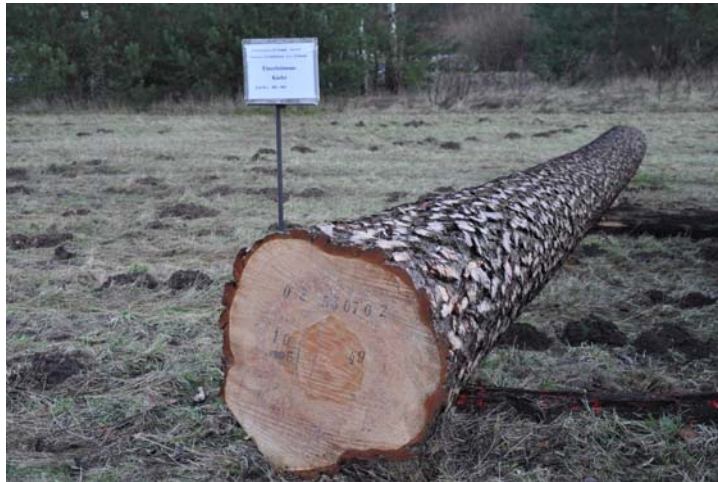
Einzelstamm Kiefer 02530702, 10,5 m, Durchmesser 49 cm, Submission 2013, sehr schmale Jahrringe
