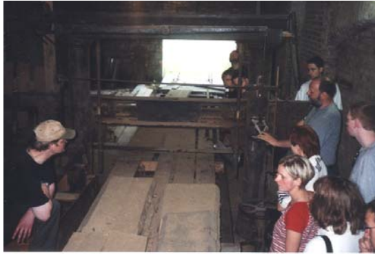
Horizontalgatter aus dem Jahre 1902 zum Einschneiden von Überlängen und Durchmesser bis 1 m
