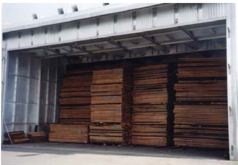
Trockenkammer zur technischen Trocknung des produzierten Schnittholzes Dämpfkammer zur Farbnuancierung des Schnittholzes und Vakuumtrockner (nicht im Bild)
