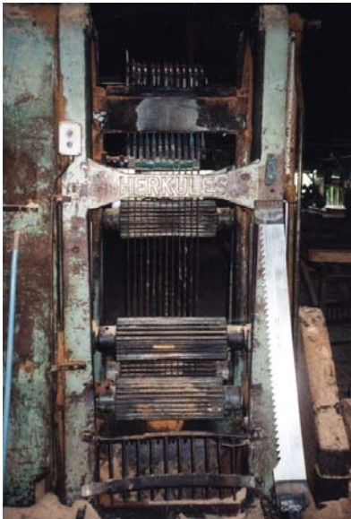
Vertikalgatter der Fa. Herkules für schwaches Laubholz (nicht mehr in Betrieb) mit einzelнем Gattersägeblatt zur Demonstration (rechts)
